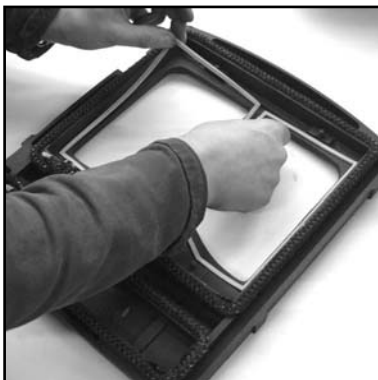
Fig. 9a fitting new door gasket
