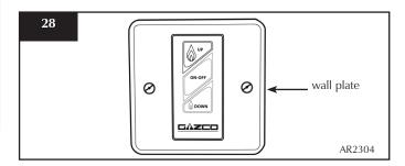
7.3 PLEASE ENSURE NO WIRES ARE TRAPPED BEFORE REPLACING THE WALL PLATE. THE TOUCH PAD LEAD IS EASILY DAMAGED.
