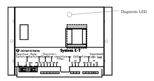
Fig. 5 **SYSTEM E-T Electronic module**
