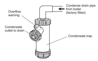
Fig. 13 - Vortex condensate trap
