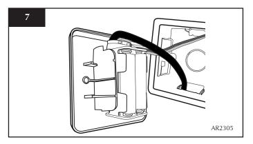
PLEASE ENSURE NO WIRES ARE TRAPPED BEFORE REPLACING THE WALL PLATE. THE TOUCH PAD LEAD IS EASILY DAMAGED
