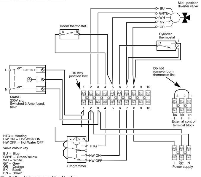
Fig. 6.19 - Not permanent live Y-plan
