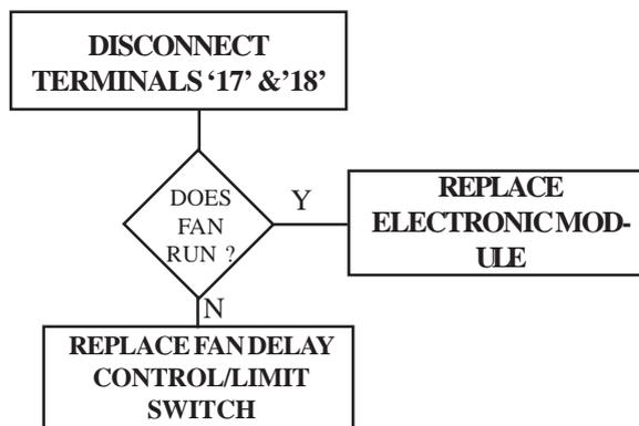
**FAN OPERATES, BUT BURNER CYCLES BEFORE REQUIRED TEMPERATURE IS REACHED**
