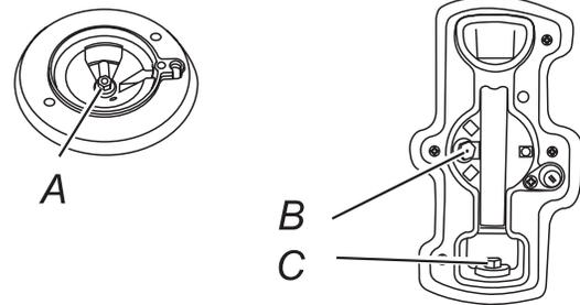
*A orifice, B internal orifice, C external orifice*
